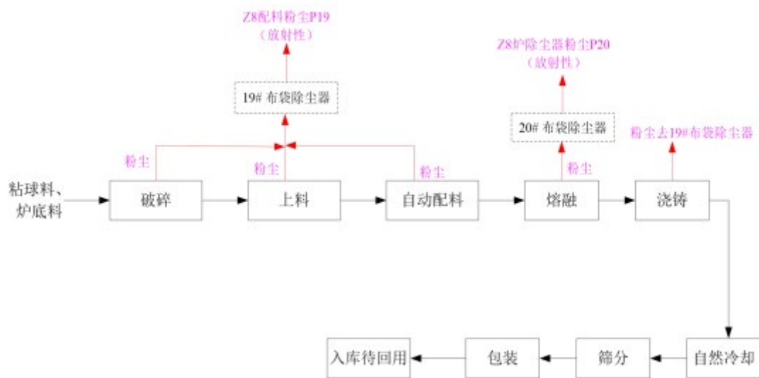
图 2-2 提纯料生产工艺流程及产污环节示意图
